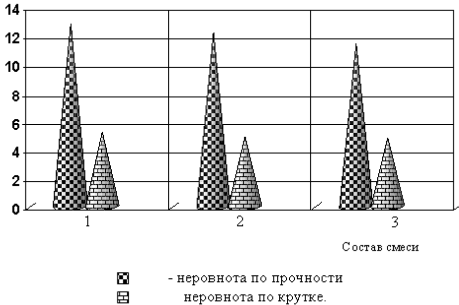
Рис. 1. Влияние смеси различных отходов на квадратическую неровноту пряжи по прочности и крутке
