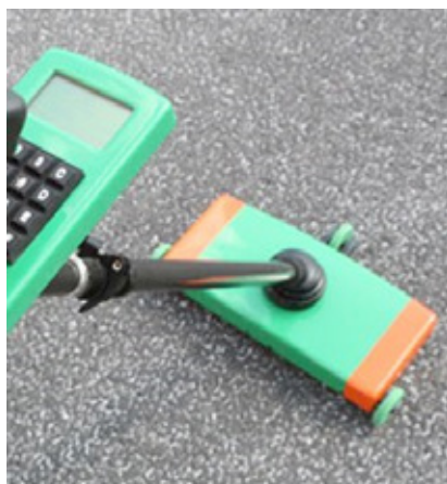
Рис. 4. Прибор для измерения толщин слоев дорожного покрытия MIT-SCAN-T2
