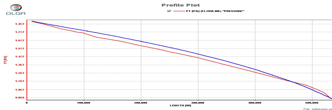
Рис.1. Распределение давлений (по ОНТП и OLGA 2006)
