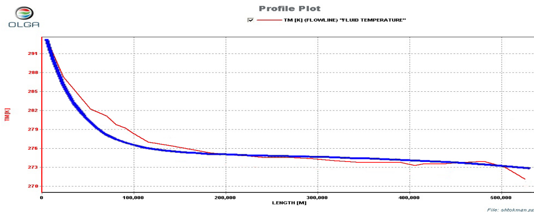
Рис.2. Распределение температур (по ОНТП и OLGA 2006)
