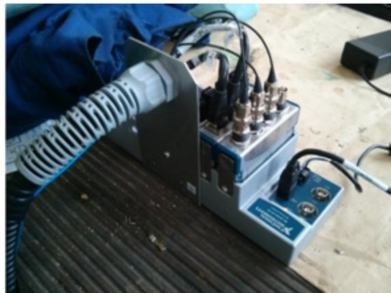
Рис. 3. Модуль подключения датчиков (тензоизмеритель) NI 9237
