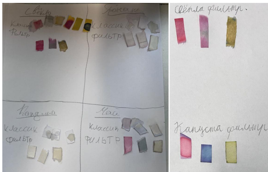
Рис. 4. Примеры тестирования бумажек, пропитанных соком капусты, свёклы, чаем каркаде. Слева на рисунке капуста не поменяла цвет, так как была нарушена технология приготовления сока из капусты
