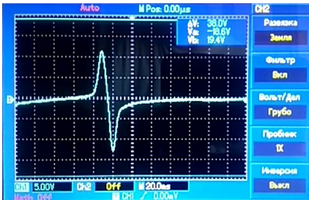
Рис. 16. Осциллограмма выходного напряжения катушки при наличии магнитопроводов
