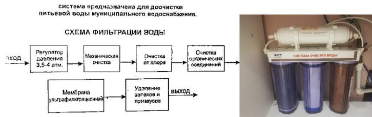
Рис. 1. Система очистки воды (фильтрующий материал-активированный кокосовый уголь)
