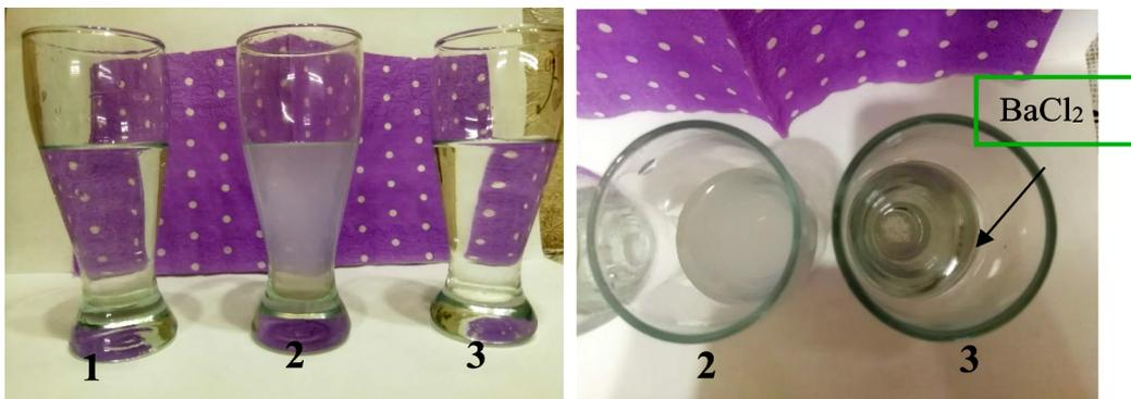
Рис. 6. Проведение анализа на сульфата 1) вода питьевая; 2) вода после одного замерзания (помутнел); 3) образец после 4-х замораживаний (реакция не прошла)
