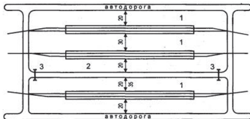
Рис. 1. Схема размещения пожарных проездов при параллельном расположении нескольких сливноналивных эстакад для легко воспламеняющихся жидкостей: 1 — эстакада; 2 — пожарный проезд; 3 — шлагбаум
