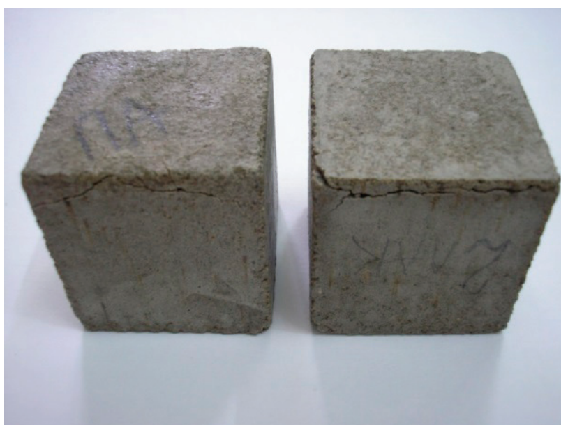
Рис. 2. Отслаивание тонкого поверхностного слоя с граней образцов, пропитанных гидрофобной жидкостью лаком «ВВМ-М-7» от воздействия мороза
