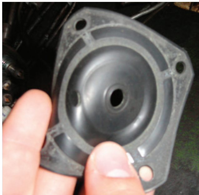
Рис. 2. Повреждение мембраны редуктора газового
