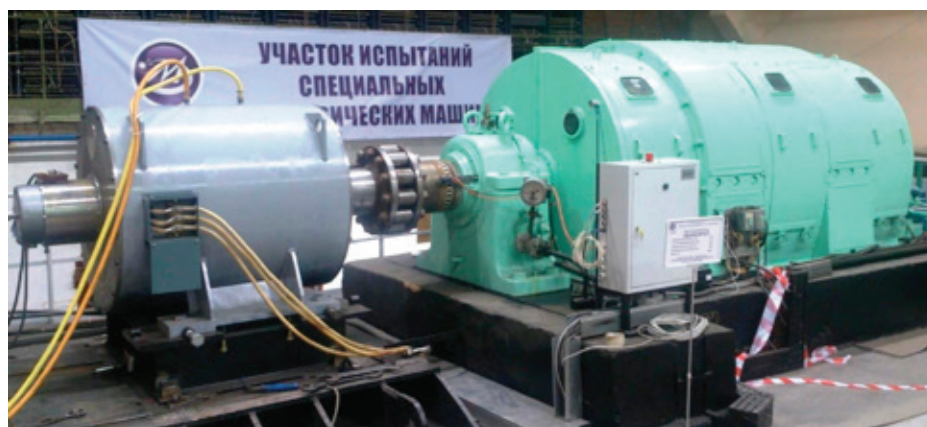
Рис. 4. Первый в мире синхронный ветрогенератор мощностью 1 МВ·А с обмотками из ВТСП второго поколения
