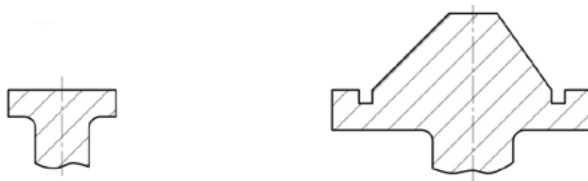
Рис. 1. Контуры направляющих станины станка НТ-250И под суппорт
