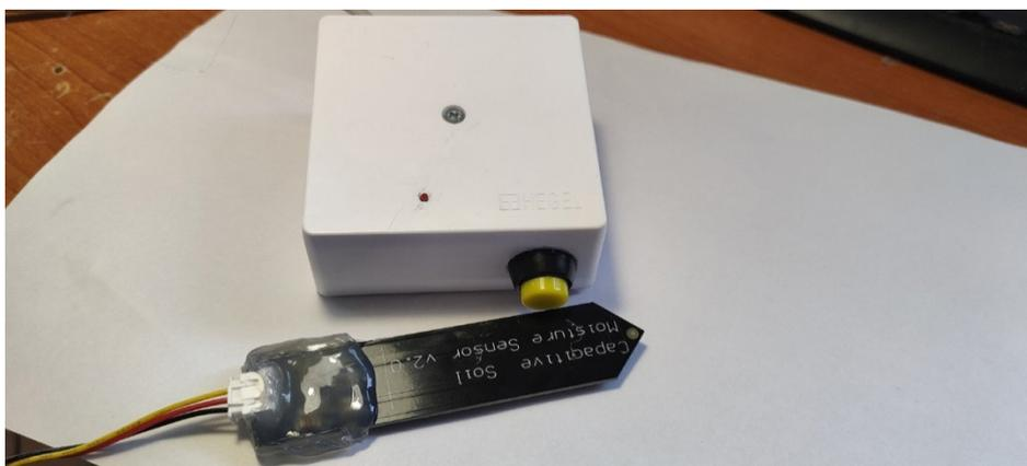
Рис. 5. Портативная бытовая метеостанция на базе микроконтроллера ESP8266–12
