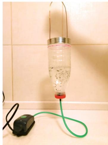
Рис. 2. Установка для барботирования
