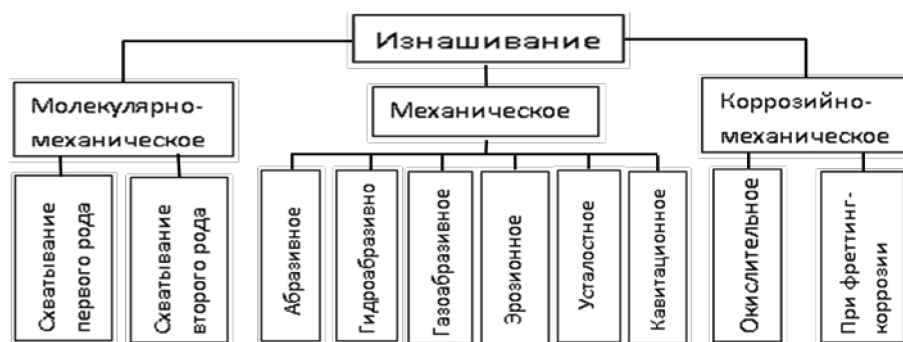
Рис. 1. Виды изнашивания деталей [3]
